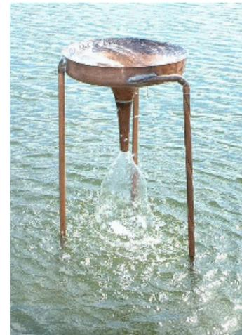
**Bild 17** Hyperbolischer Trichter in Betrieb
